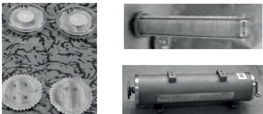
Рис. 2 – Чашки Петри и пакеты с тест-объектами из хлопчатобумажной ткани (а), сборка из 24 чашек Петри (б), контейнер «Биориск-МСН» в сборе (в) (фото ГНЦ РФ-ИМБП РАН).
